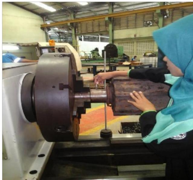
**2.5 Gambar Penyetelan Roller Menggunakan Dial**
