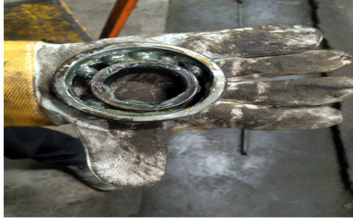
Gambar 3.7 Bearing Yang Mengalami Keausan
