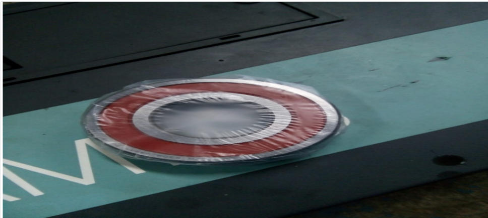
Gambar 3.6 Bearing Yang Masih Bagus Kode:6308
