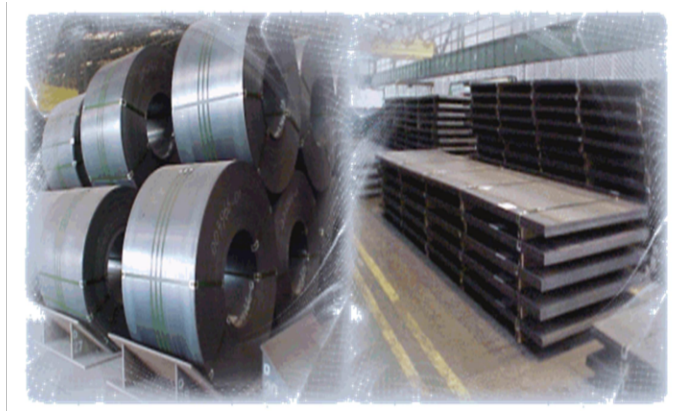
Gambar 2.11 Hasil Proses produksi HSM
