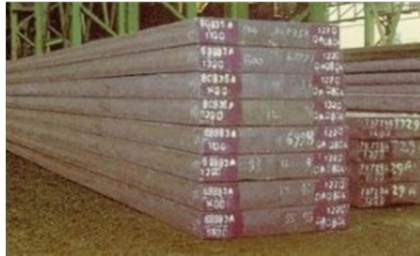
Gambar 2.9 Hasil Produk Slab Baja
