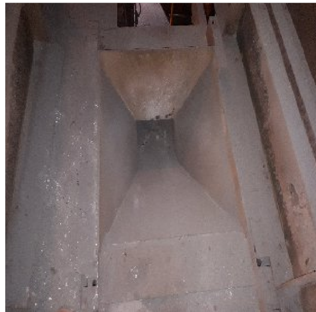
Gambar. 4.4 tempat pembuangan bahan tambahan menuju ladle
