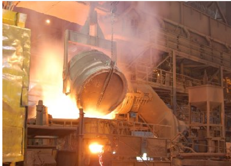
Gambar 3.9 Pemasukan bahan baku ke dalam dapur (EAF)
