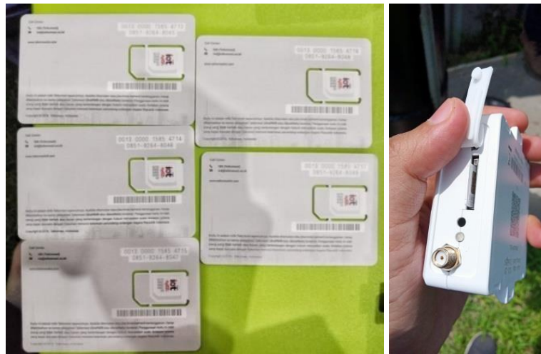
Gambar 4.11 GSM Telkomsel dan Pemasangan GSM Pada Modem
