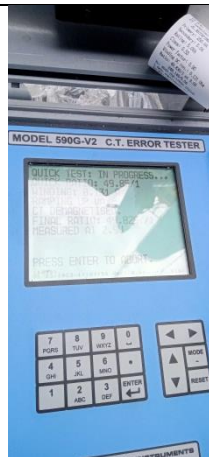
Gambar 14. Hasil Print Uji Error Trafo CT Pelanggan 3 Fasa sebelum dipasang
