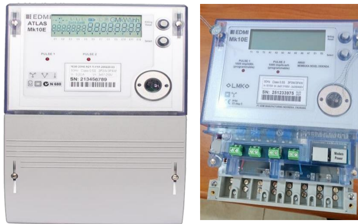
Gambar 4.6 kWh Meter EDM I Mk10E
