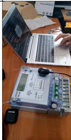
Gambar 7. Setting kWh Meter 3 Fasa Merk EDM I sebelum di pasang pada pelanggan
