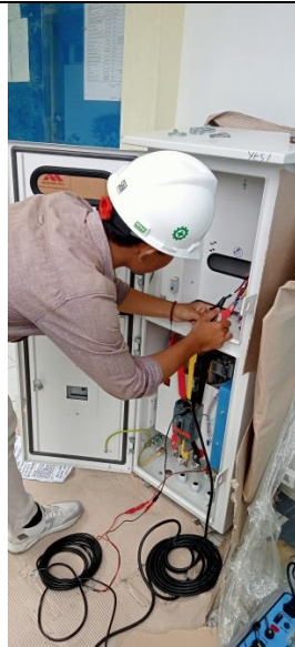
Gambar 2. Pengujian error Trafo CT dengan CT Error Tester
