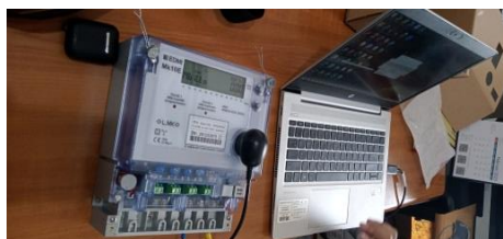
Gambar 4.8 Setting Konfigurasi Meteran 3 Fasa Pelanggan UP3 Padang
