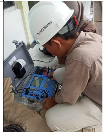
Gambar 8. Setting CT Error Tester Sebelum digunakan
