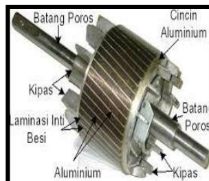
Gambar 21 Rotor sangkar tupai dan bagiannya Celah udara (air gap)
