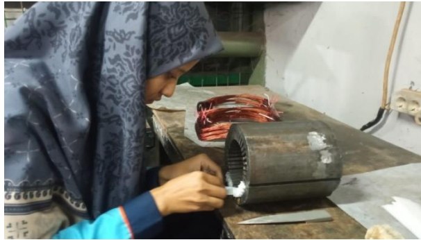
Gambar 24. Pemasangan Prespan (Sumber: Dokumentasi PLI)
