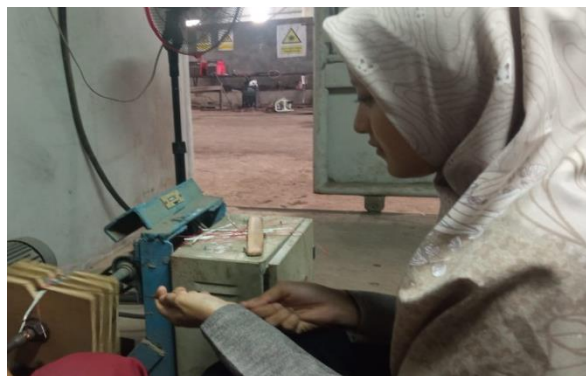
Gambar 26. Pengulungan kawat dengan mal (Sumber: Dokumentasi PLI)
