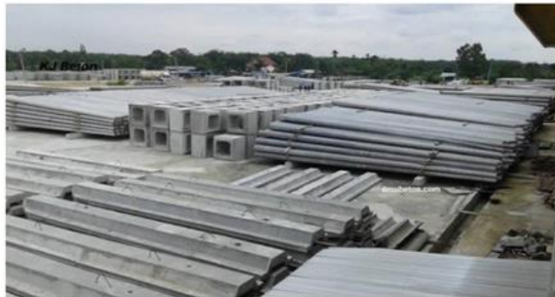
Gambar 5. Tiang Pancang Kotak (Sumber: Dokumentasi PLI)
