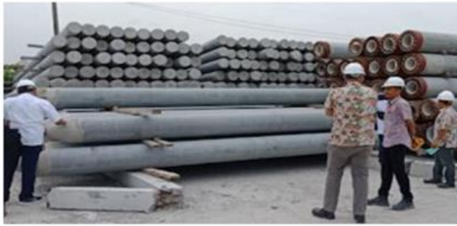
Gambar 4. Tiang Listrik Beton (Sumber: Dokumentasi PLI)
