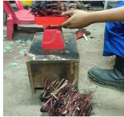
Gambar 22. Proses Pendataan Winding Stator (Sumber: Dokumentasi PLI)
