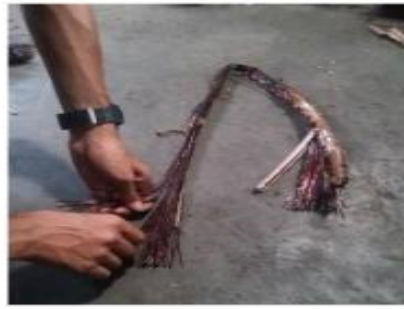
Gambar 22. Proses Pendataan Winding Stator (Sumber: Dokumentasi PLI)
