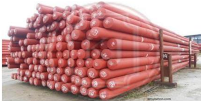
Gambar 7. Tiang Listrik Besi (Sumber: Dokumentasi PLI)
