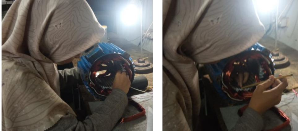
Gambar 27. Pemasangan kawat pada alur (Sumber: Dokumentasi PLI)
