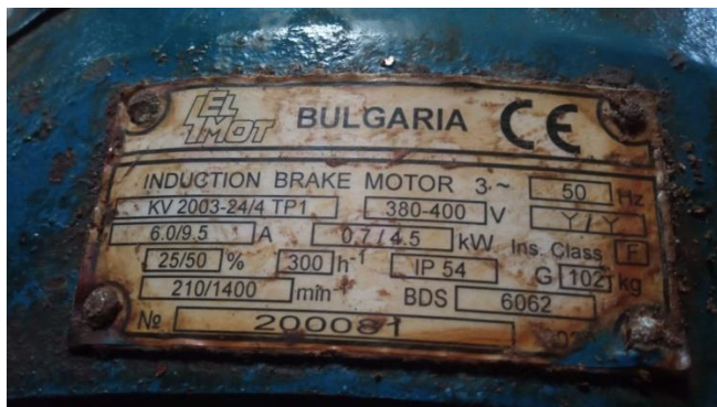
Gambar 9. Name plate motor induksi 3 fasa (Sumber: Dokumentasi PLI)
