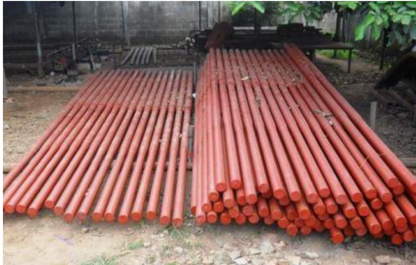
Gambar 3. Tiang Baja Sambungan SUTR dan SUTM.
