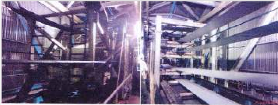
Gambar 38. Looper CTCM : (a) kereta looper dan (b) strip saat di looper
