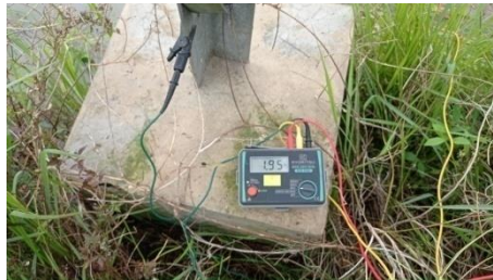
Gambar 6. Hasil Pengujian Pentanahan
