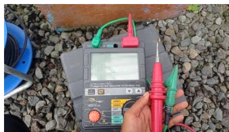
Gambar 21. Megger Kyoritsu Type 3125
