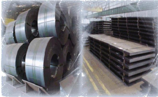
Gambar 2.11 Hasil Proses produksi HSM
