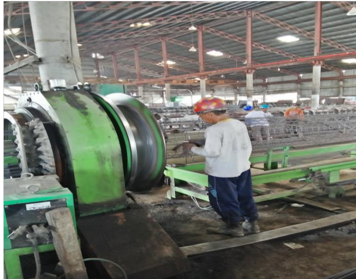
Gambar 9. Cage Forming ( Pembuatan Sangkar ) Sumber : PT . Jaya Sentrikon Indonesia
