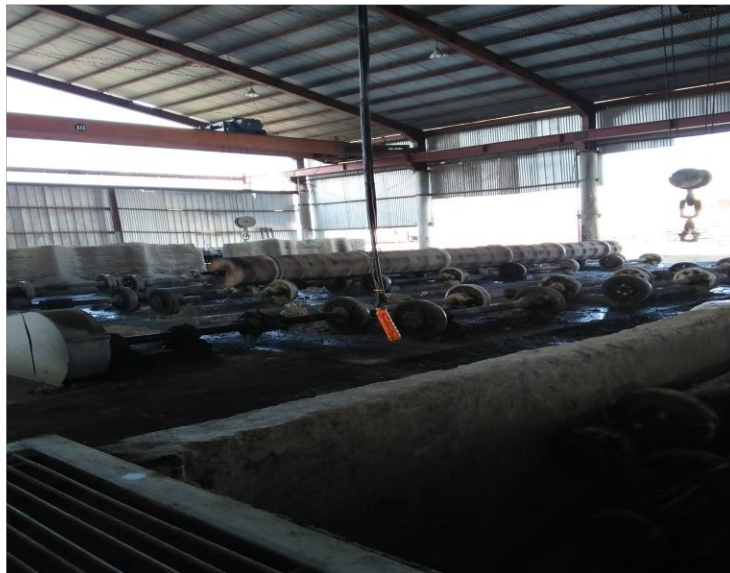
Gambar 14. Spining ( proses pemadatan )
