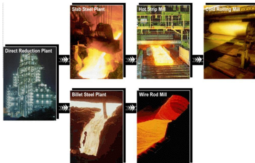
Gambar 2.3 Flowchart proses produksi PT. Krakatau Steel
