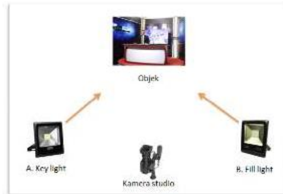
Gambar 2.7 Teknik pencahayaan Key light dan Fill lihgt pada objek
