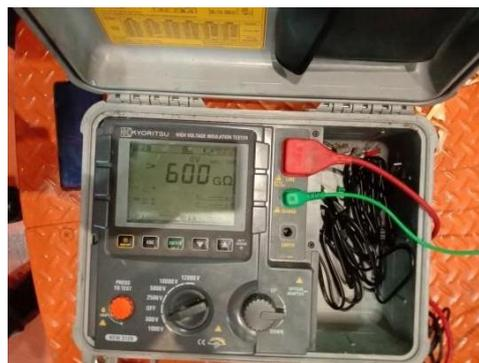
**Gambar 2. 18 Pengukuran Tahanan Isolasi Sebelum Varnish**
