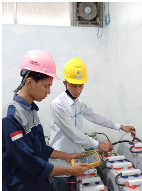
**Gambar 2. 13 Pengujian Tegangan Baterai**
