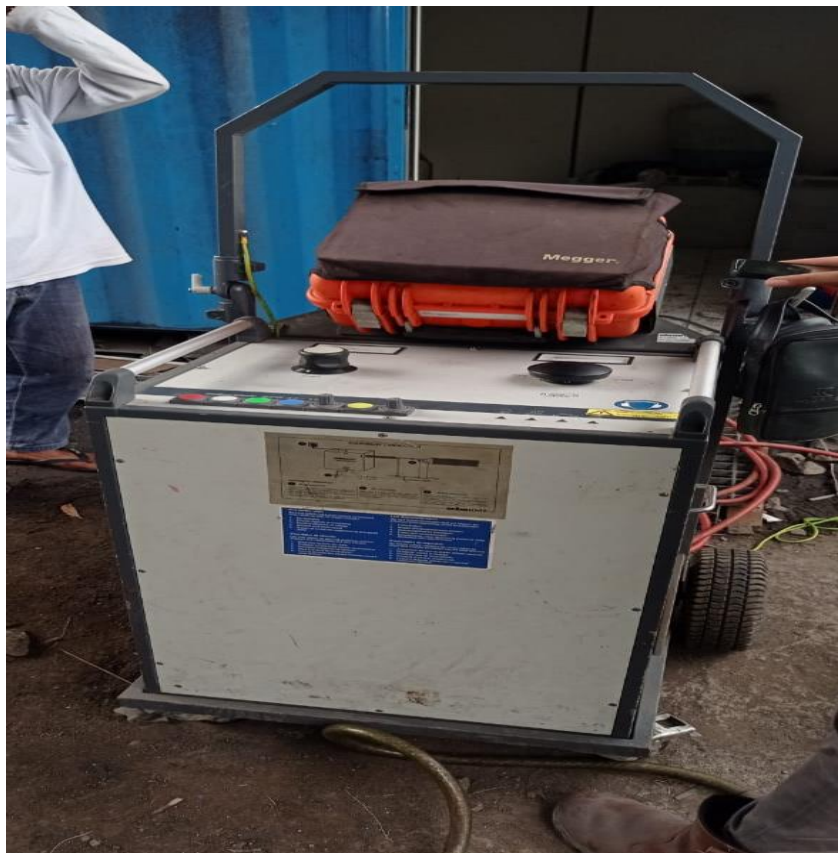
Pengecekan Isolasi Kabel dengan Hypo Test dan Megger
