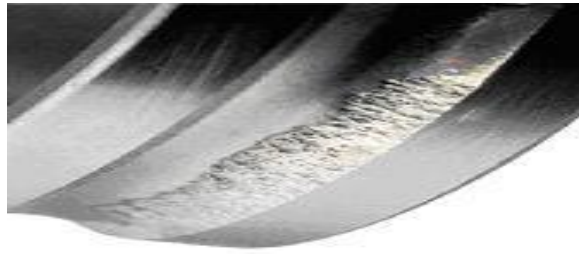
Gambar 3.11 Tanda-tanda Kerusakan pada Bearing.
