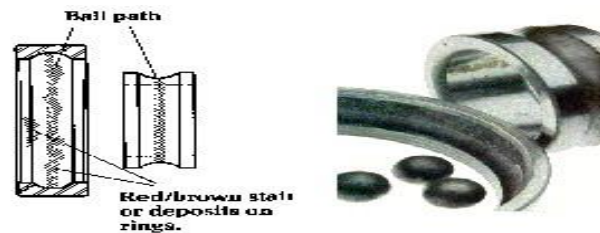
Gambar 3.12 Korosi pada Bearing.
