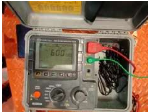
Gambar 2. 18 Pengukuran Tahanan Isolasi Sebelum Varnish
