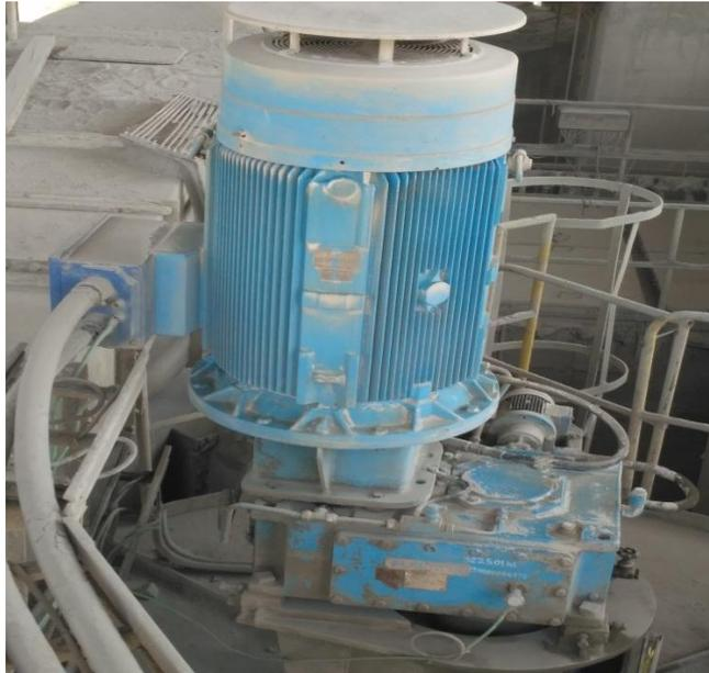
Gambar 14: Motor Penggerak *air vanes/rotor*
