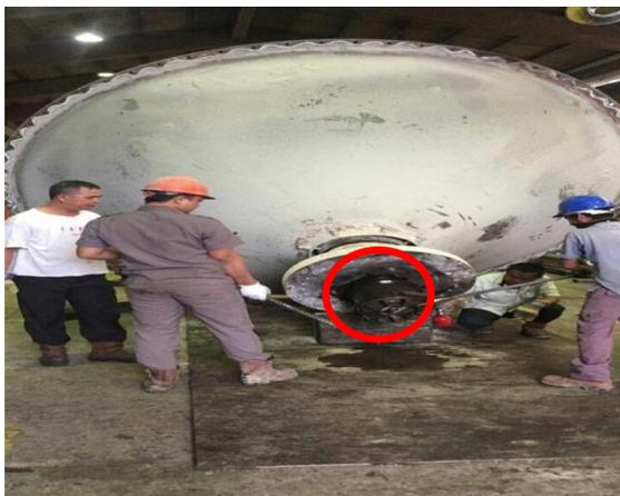
Gambar 20: Proses Pembukaan *Bearing Rotor*
