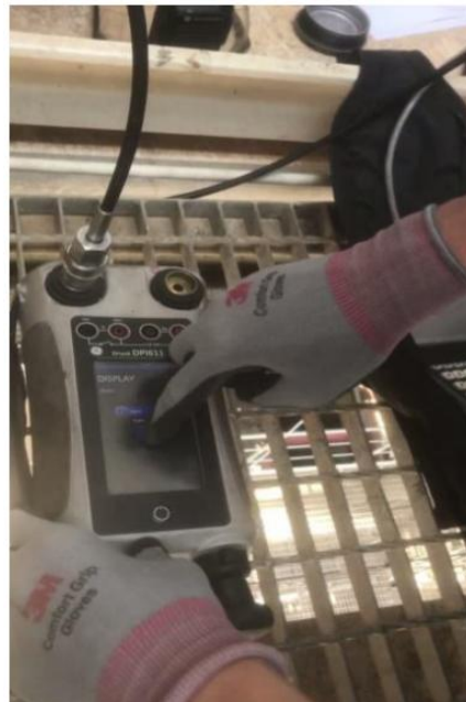
Gambar 27. Setting zero pada Hand Pump
