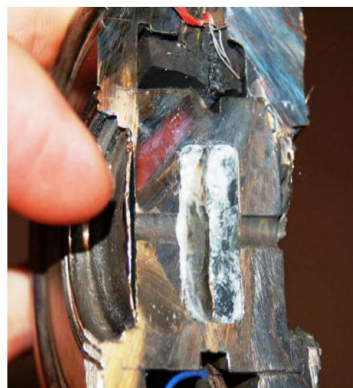
Gambar 19. Bagian dalam sensor diafragma Differential Pressure Transmitter
