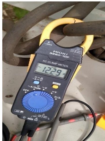
Gambar 10. Pengukuran arus PHB-TR
