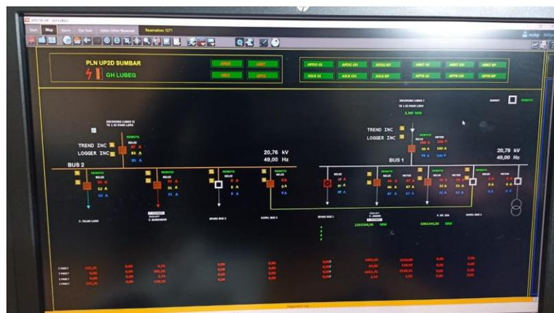
Gambar 4. 44 Tampilan GH LUBEG pada Workstation setelah Test Commisioning
