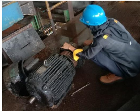
Gambar 2. 12 Melepas mur penutup rangka motor
