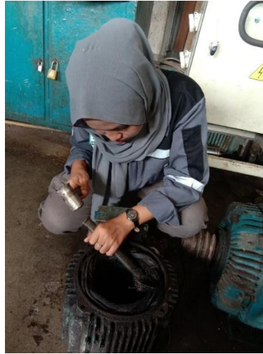
Gambar 2.14 Proses pencabutan gulungan stator
