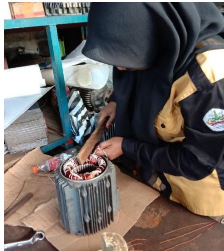
Gambar 2.19 proses pengikatan winding dengan pita ban
