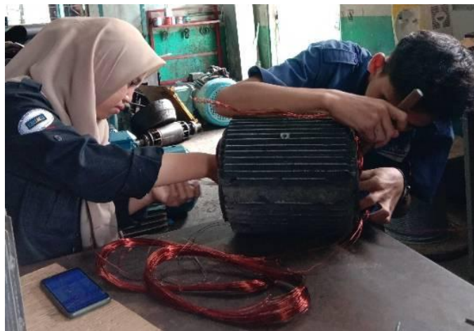
Gambar 2.17 proses menggulung lilitan pada kumparan stator
