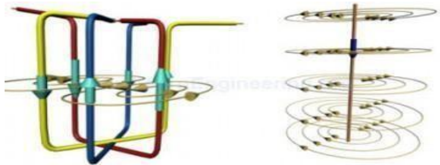
Gambar 22. Arus Pada Kabel Menghasilkan Fluks
