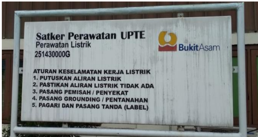
Gambar 5. Papan petunjuk aturan keselamatan kerja listrik
