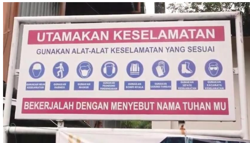
Gambar 4. Papan simbol K3 untuk alat pelindung diri (APD)
