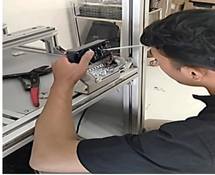
Gambar 2.56 Wiring Junction Box (Sumber : Dokumentasi Pribadi)
