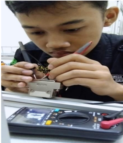
Gambar 2.64 Penyolderan dan Commissioning I/O DB25 (Sumber : Dokumentasi Pribadi)
