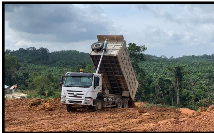
Gambar 13. Dumping Overburden PT Pengembangan Investasi Riau
