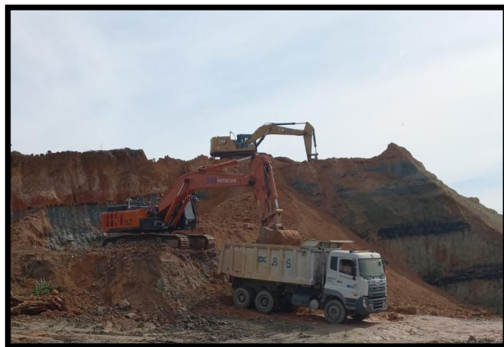
Gambar 33. Pola Muat Top Loading
