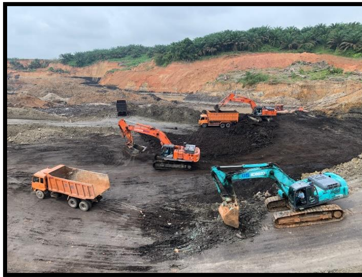
Gambar 11. Loading Overburden PT Pengembangan Investasi Riau
