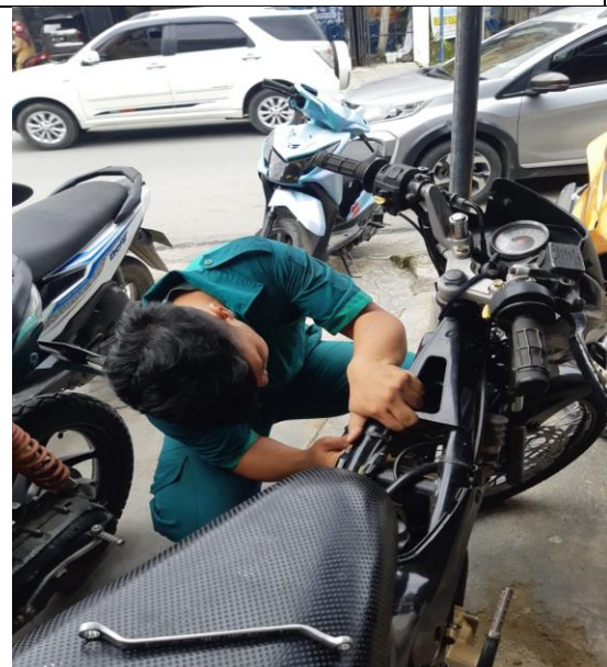
Gambar 11 Proses Pengecekan Setelah Pemasangan Koil Satria Fu Yang Baru
