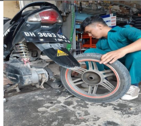
Gambar 9 Pemasangan Kampas Rem Spin 125
