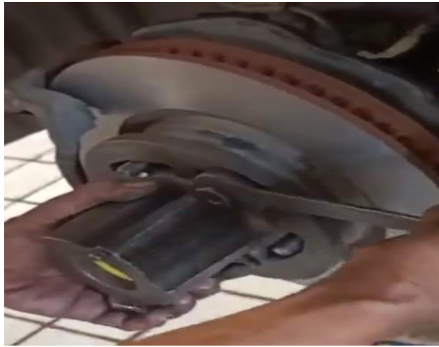
Gambar 17. Cara Melakukan Rematching Disc Brake
