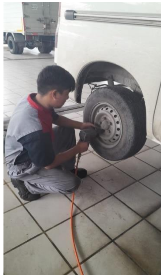
Gambar 19. Melakukan pengecekan kampas rem dan memasang roda belakang
