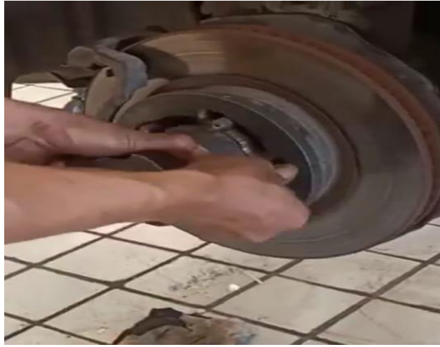
Gambar 7. Cara Melakukan Rematching Disc Brake
