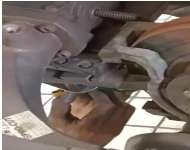
Gambar 15. Cara Melakukan Rematching Disc Brake
