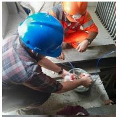
Gambar 21. Menuangkan minyak ke dalam bejana uji
