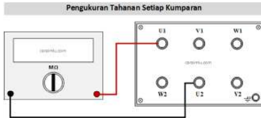
Gambar 17: Pengukuran tahanan isolasi setiap kumparan
