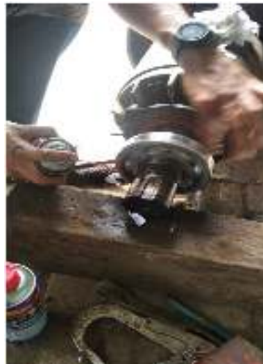
Gambar 20: Membersihkan Bearing dengan WD
