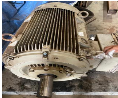
Gambar 2. 31 Motor ID FAN DCB 160 kW
