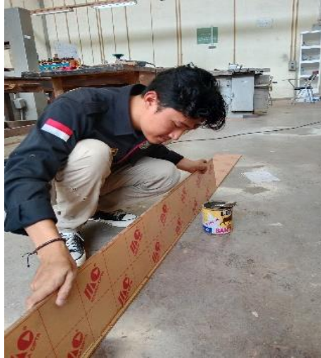
Gambar 24. Proses Pengeleman Akrilik (sumber: Dokumentasi Pribadi,2022)
