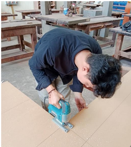
Gambar 23. Pemotongan Akrilik Menggunakan Mesin Jigsaw (sumber: Dokumentasi Pribadi,2022)
