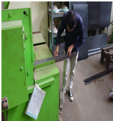
Gambar 17. Besi Di Potong Menggunakan Mesin Shearing (sumber: Dokumentasi Pribadi,2022)
