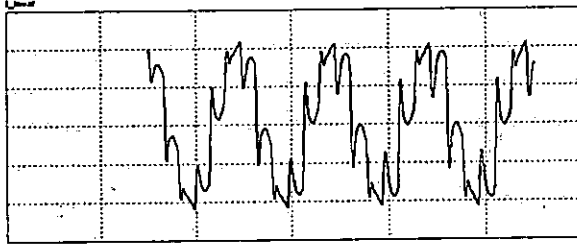
Gambar 3.16 Gelombang arus injeksi setelah pasang hybrid filter aktif
