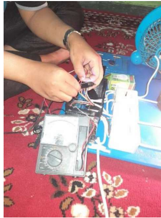
Gambar 41. pengukuran saat diberikan logika HIGH
