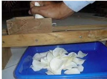
Gambar 2. Proses Pengirisan Secara Manual (Sumber : Pinterest)
