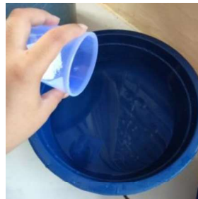
Gambar.14 Proses Pelarutan Tawas Dengan Air Sumber Gambar : Dokumentasi Pribadi
