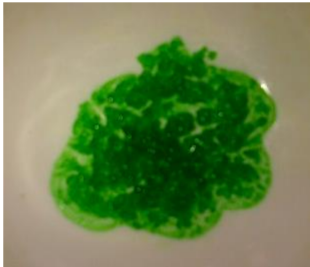
Gambar 12. Gel nikel oksida menggunakan prekursor nikel asetat tetrahidrat
