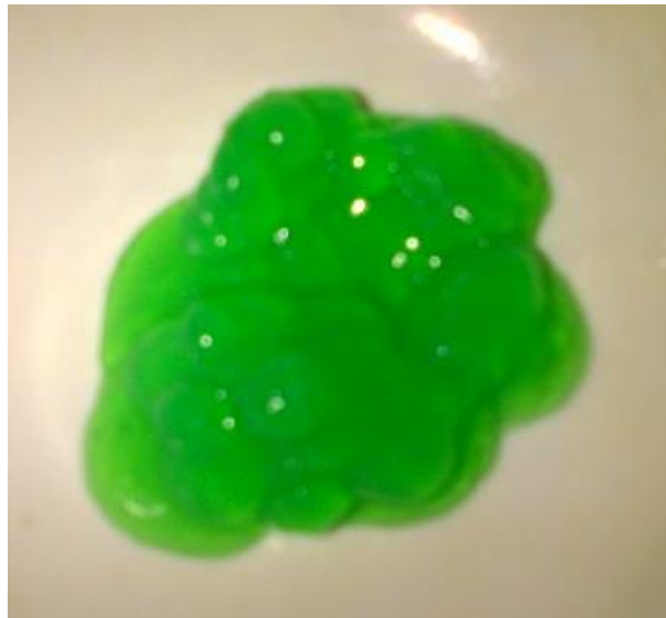
Gambar 9. Sol nikel asetat tetrahidrat menggunakan metanol
