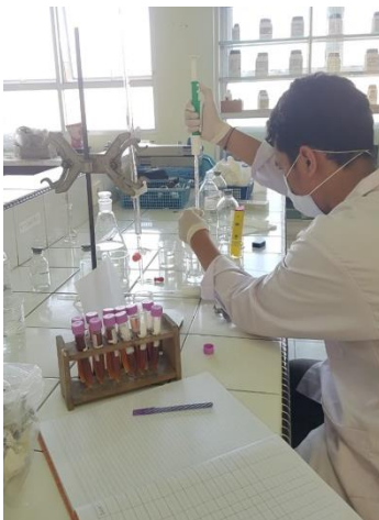
Pergukuran Kadar Asam Asetat Ecoenzyme dari Bahan Organik Variasi Kulit Jeruk Manis dan Asam pada Fermentasi 14 dan 100 dengan Metode Titrasi Asam Basa
