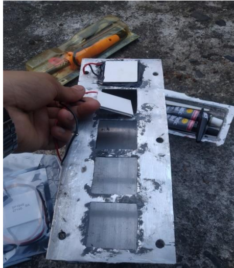
Pemasangan Modul Thermoelectric ke dudukannya
