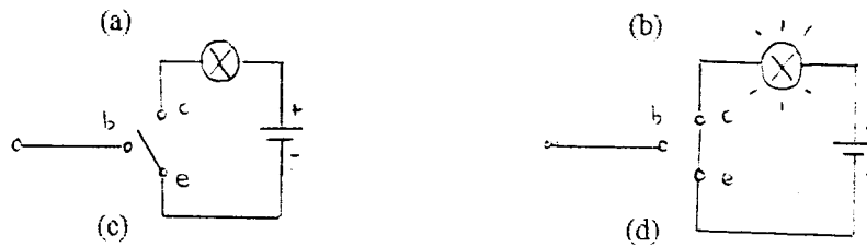
Gambar 6. Pensakelaran oleh transistor. (Hall, 1985 : 23)
