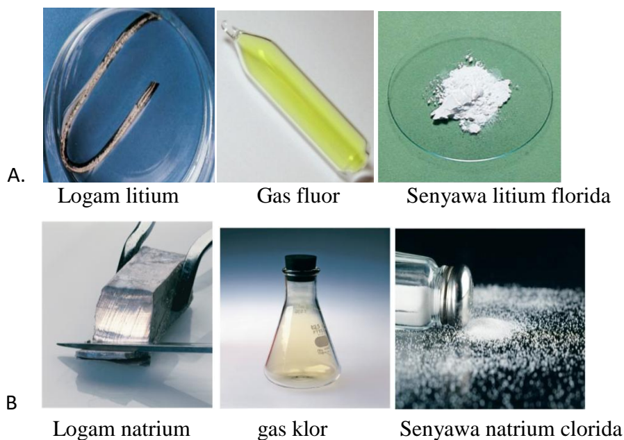
Gambar 3. (A) Logam litium (1A), gas fluor (7A), dan senyawa Ion LiF yang dibentuk dari reaksi logam litium dengan gas fluor; (B) Logam natrium (1A), gas klor (7A), dan senyawa ion NaCl (Chang, 2010)
