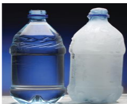
Gambar 73. Ekspansi air saat pembekuan (Brown, et al. , 2012: 434)
