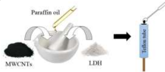
Gambar 2. Persiapan elektroda dimodifikasi (MWCNTs: multiwalled nanotube karbon, LDH: berlapis hidroksida ganda).
