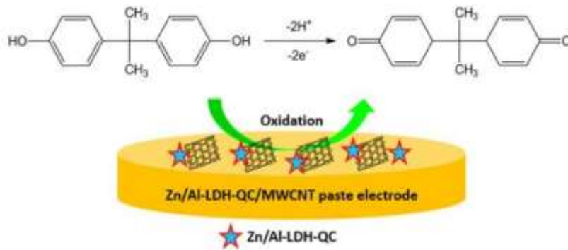
Skema 1. Reaksi elektro -oksidasi bisphenol A pada permukaan elektroda selama penginderaan elektrokimia.
