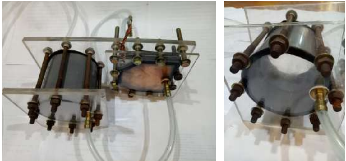
Gambar 6. Produk Generator. Pelat elektroda yang digunakan 10 cm x 10 cm. Ketebalan Plat Al 0.7 mm dan Pelat Tembaga 0.4 mm. Ukuran Akrilik supporting 14 x 10 cm dan tebal 2 mm. Diameter 10 cm untuk water reservoir sebelum masuk ke generator. Elektroda yang dipakai secara berselang seling dan berlapis dengan ketebalan pemisah yang tak kontak 1 mm.
