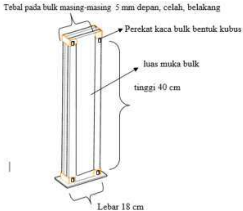
Gambar 1. Skema dan design sel fotoreaktor planar
