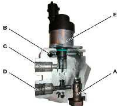
Gambar 110. Bentuk fuel control valve
