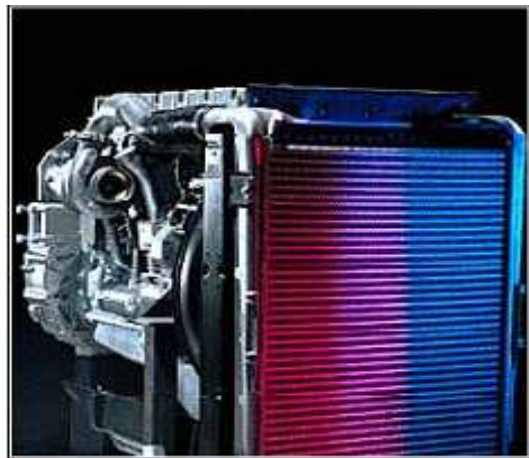
Gambar 158. Bentuk intercoller pada mesin
