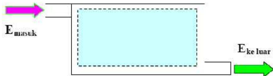
Gambar 58. Perubahan energi pada sistem terbuka
