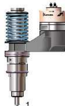
Gambar 95. Unit injektor tipe lucas A3
