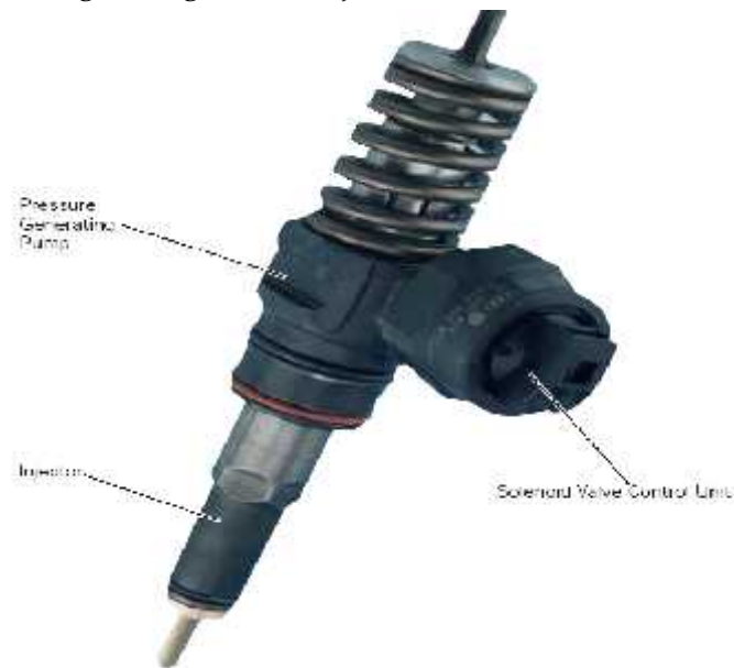
Gambar 92. Unit injektor dan bagian-bagiannya
