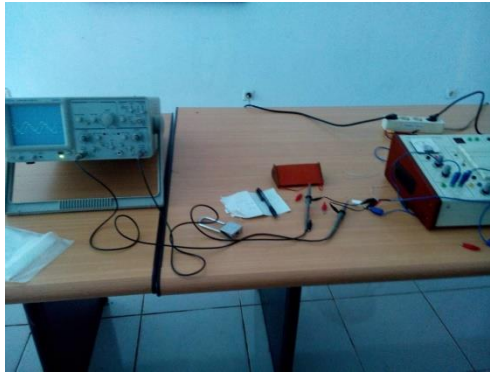
Gambar 6 . Set Eksperimen osiloskop, audio function generator (AFG), resistor 2 \Omega dan solenoida di laboratorium
