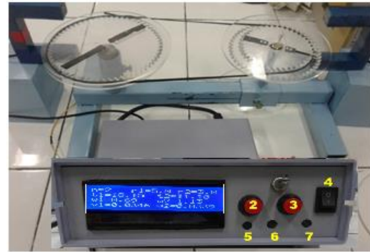
Gambar 2. Hasil peralatan praktikum gerak melingkar
