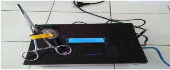
Gambar 11. Foto hasil desain pengukur tekanan pada klem arteri mosquito berbasis sensor proximity LJ12A3-4/BX
