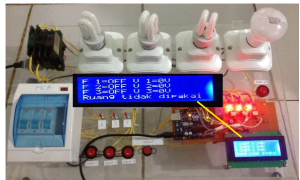
Gambar 7 Tampilan hasil pengkondisian OFF terhadap MCB fase R, fase-S, dan fase-T
