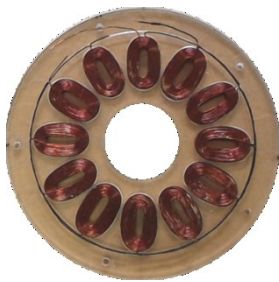
Gambar 12. Konstruksi stator generator dengan 12 lilitan kumparan
